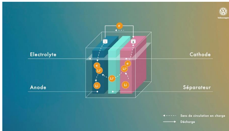
Figure 4 : Principe et fonctionnement de la batterie Lithium -ion. (Darding, 2021)
