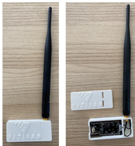
Figure 4 : Passerelle créée grâce à un ESP32
