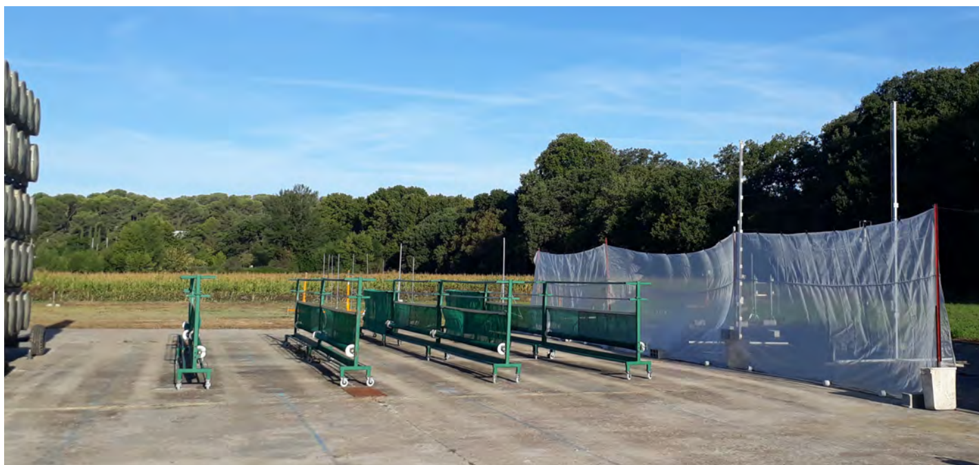
Photo d'un essai réalisé en conditions artificielles (soufflerie et vigne artificielle) à l'UMT ECOTECH de Montpellier
